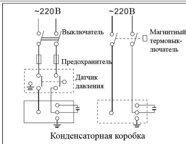
**Внимание!** Указанное в схеме устройство защиты мотора (магнитный термовыключатель) не входит в комплект с насосом.
