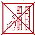
недостаточная тяга (Не используйте котел!)
