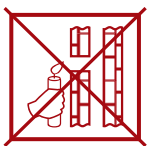
недостаточная тяга (Не используйте котел!)
