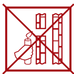
недостаточная тяга (Не используйте котел!)
