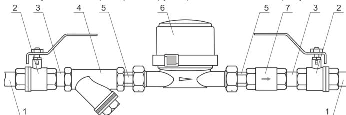
**Рисунок 3 – Пример монтажа счётчика в трубопровод**
