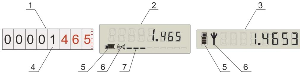
**Рисунок 1 – Пример отображения данных на индикаторе МСУ/ЭСУ**
