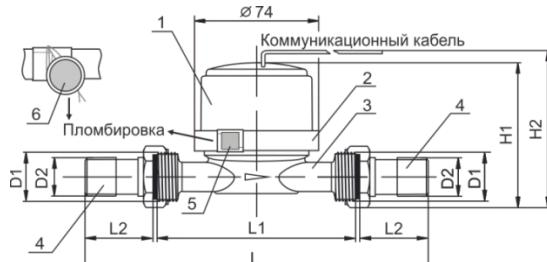
**Рисунок 2 – Габаритные и присоединительные размеры счётчика воды и места пломбировки**
