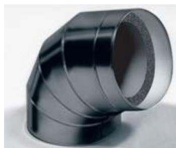
Готовые углы с сегментами по 45° или 90° с гибким краем стандартных размеров. Устанавливаются поверх теплоизоляции. Необходимый угол устанавливается на предварительно заизолированную часть конструкции так, чтобы его края немного перекрывали друг друга. Край фиксируется с помощью самоклеящейся ленты IC CLAD или IN CLAD.
