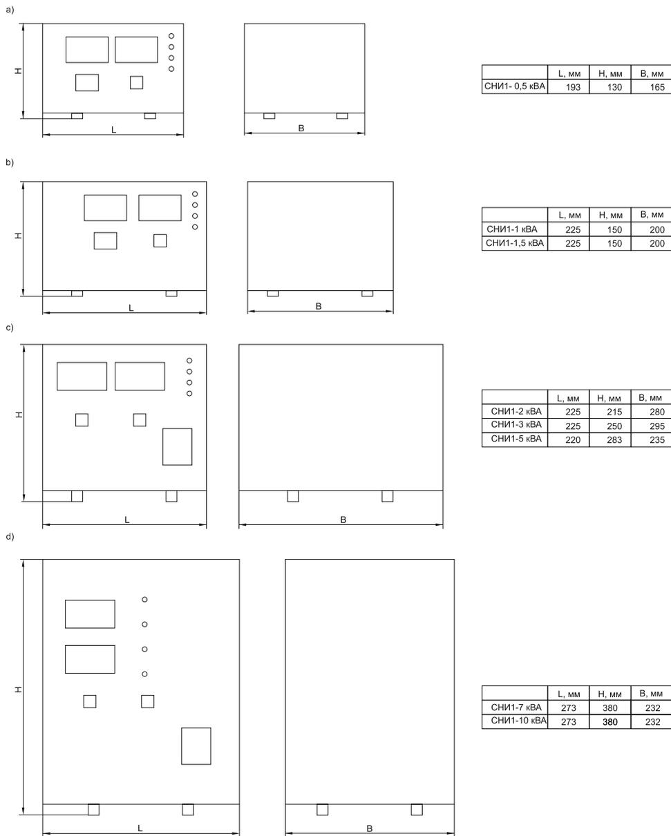
Рисунок 1 – Габаритные размеры:
