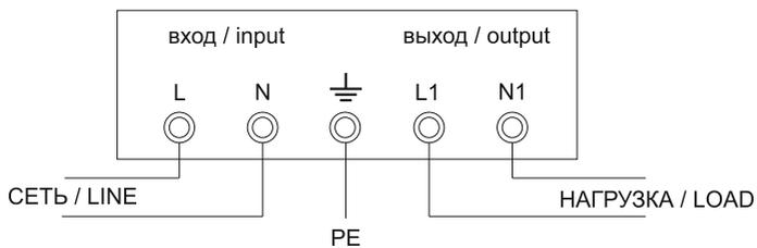
Рисунок 6 – Схема подключения СНИ1 от 2 до 10 кВА
