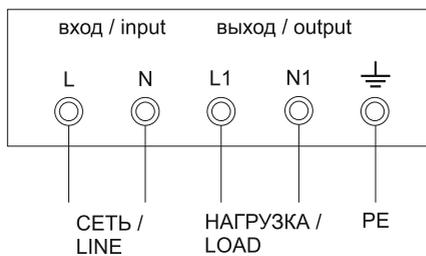
Рисунок 7 – Схема подключения СНИ1 от 15 до 30 кВА
