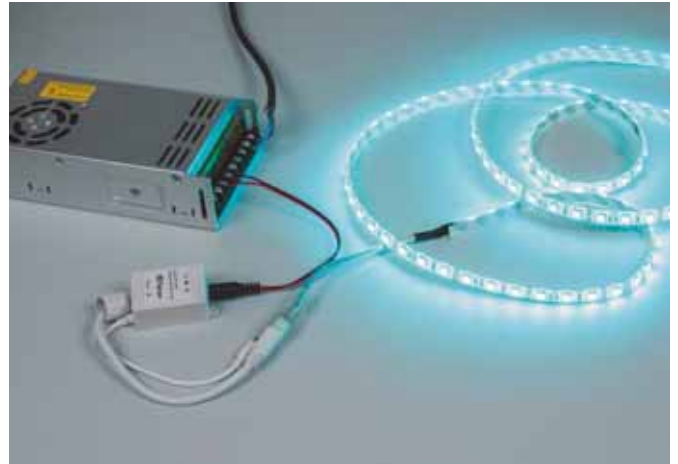
Подключенная лента RGB длиной 5 метров.
