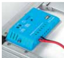
Контроллер 10А расположен на оборотной стороне панели
