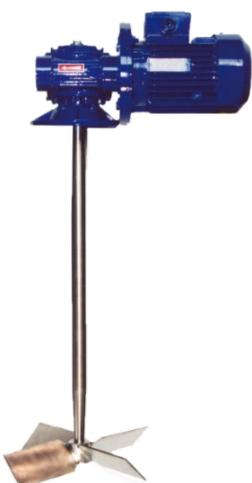
4-х лопастные низкооборотные мешалки предназначены для перемешивания жидкостей (флокулянтов, коагулянтов, растворов полиэлектролитов и т.п.), в объеме не более 5 м3. Стандартное исполнение электродвигателя: 230/400V-50Hz - 3 фазы, 1400 об/мин. Редуктор: 70 – 90– 140 об/мин. Стандартное исполнение: вал с 4-мя рабочими лопастями выполнен из н/ст AISI 304 под углом 45 градусов.
