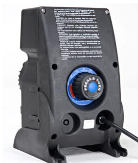
Пример: для того, чтобы дозировать 4 л/ч насосом 8 л/ч – 10 бар, при максимальной частоте импульсов (222 в минуту), необходимо установить ручку регулировки длины хода пистона в среднее положение, что будет соответствовать приблизительно 50% требуемого объема впрыска.
