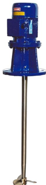
Высокооборотные миксеры предназначены для перемешивания реагентов в малых и средних емкостях. Стандартное исполнение электродвигателя: 230/400V-50Hz - 3 фазы, 4-х полюсные 1400 об/мин (AGV 1400) и 6-ти полюсные 900 об/мин (AGV 900). Класс пылевлагозащиты: IP55. Стандартное исполнение: н/ст AISI 304; по запросу: н/ст AISI 316, ПП или ABICITE. Радиальный подшипник с уплотнением. Винт (пропеллер) изготовлен с углом 35 градусов - три лопасти; по запросу: две или четыре лопасти, с углом 45 градусов
