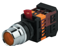
Б0045649 Кнопка ABLF-22 Ø22мм 240В 1з+1р Цвет: Желтый Подсветка: Неон
