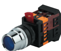
Б0045651 Кнопка ABLF-22 Ø22мм 240В 1з+1р Цвет: Синий Подсветка: Неон
