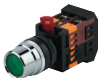
Б0045650 Кнопка ABLF-22 Ø22мм 240В 1з+1р Цвет: Зеленый Подсветка: Неон
