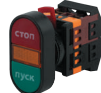
Б0045625 Кнопка APBB-22N "Пуск- Стоп" Ø22мм 240В 1з+1р Цвет: Красный/Зеленый Подсветка: Неон
