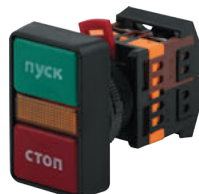
Б0045627 Кнопка PPBB-30N "Пуск- Стоп" Ø30мм 240В 1з+1р Цвет: Красный/Зеленый Подсветка: Неон
