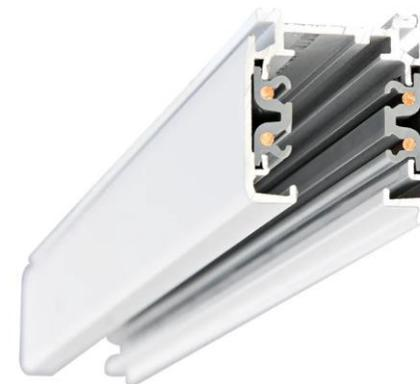
Трехфазный трековый шинопровод предназначен для фиксации и подачи питания на трехфазные трековые светильники. Монтируется накладным и подвесным способом. Напряжение питания 220-240В 50-60 Гц. Токоведущие жилы выполнены из меди. В отличие от однофазного трекового шинопровода имеет 4 токоведущие жилы, позволяющие разделять светильники на одном шинопровode на 3 независимые группы и управлять ими при помощи трехклавишного выключателя.
