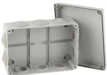
Б0047266 KORv-190-140-70-10g 190 x 140 x 70 4 винта гермовводы d32 - 10 шт.
