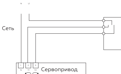
Схема электрического подключения сервопривода ESBE ARA561
