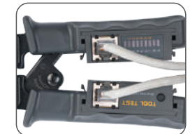
Тестирование кабельной линии
