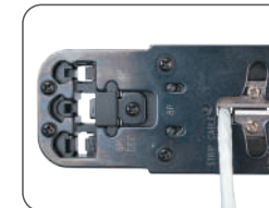
Зачистка круглого провода
