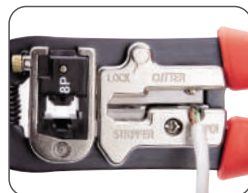
Зачистка круглого провода
