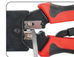
Зачистка плоского провода
