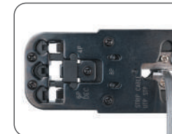
Зачистка плоского провода
