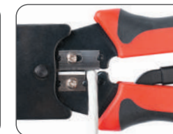
Зачистка круглого провода
