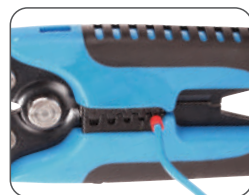
Опрессовка наконечника НШВИ
