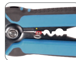
Опрессовка изолированного наконечника
