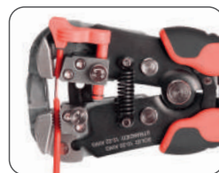
Снятие изоляции с проводов
