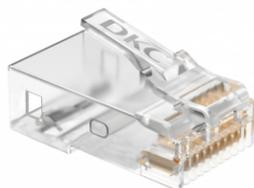
Корпус коннектора выполнен из поликарбоната. Внутри корпуса, ближе к передней части расположены ножи с технологией IDC. Ножи универсальные (для одножильного и многожильного кабеля)
