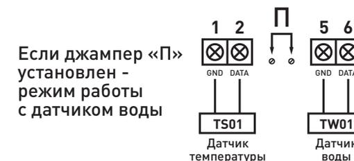
Если джампер «П» установлен - режим работы с датчиком воды
