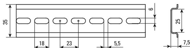
**DIN-рейки перфорированные толщиной 1 и 1,5 мм**
