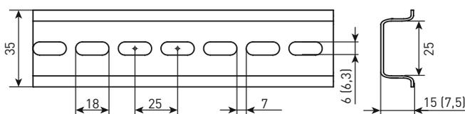
В скобках указаны размеры для DIN-рейки перфорированной 35 × 7,5 × 1 мм
