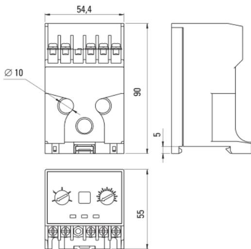
Рис. 1 Габаритные размеры реле (20А)
