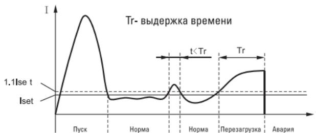
Рис. 5 Диаграмма работы реле при перегрузке
