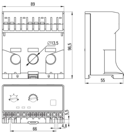
Рис. 2 Габаритные размеры реле (80А)
