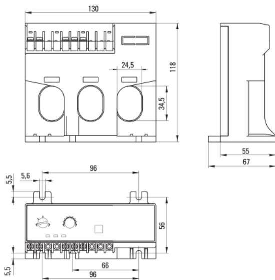
Рис.3 Габаритные размеры реле (200 и 400А)
