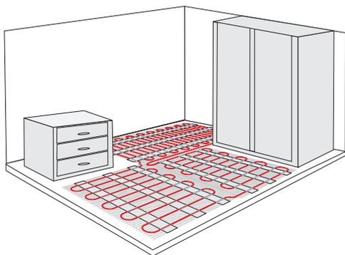
3) Под полученную полезную площадь выберите нагревательный мат, площадь которого примерно равна или меньше площади обогрева. Внимание! Площадь нагревательного мата не может превышать полезную площадь обогрева.
