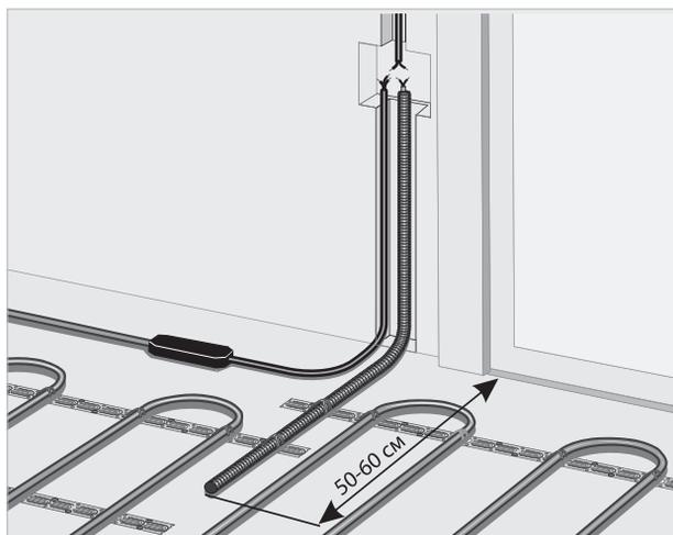
9) Залейте нагревательный мат слоем раствора для крепления плитки толщиной 5–8 мм и дайте ему высохнуть в соответствии с инструкцией по применению используемой плиточной смеси.
