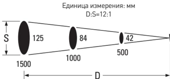
При измерении термометр будет излучать свет в виде кольца-индикатора. Измеренная температура – это температура поверхности объекта в пределах кольца
