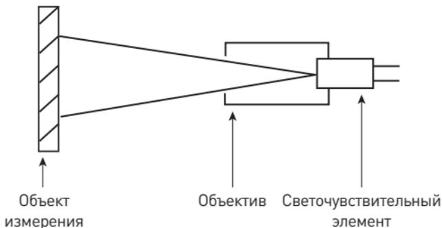
Необходимо удостовериться, что обследуемый объект целиком перекрывает поле зрения термометра, и в поле зрения не попадает ничего, кроме объекта. Чем больше объект измерения, тем больше может быть расстояние между ним и термометром при измерении температуры. Чем меньше объект, тем ближе к нему необходимо размещать термометр. Соотношение между расстоянием до объекта и его размером (D:S) составляет 12:1.
