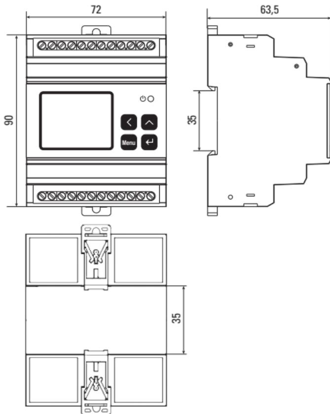
Рис. 1 - Форма и размеры счетчика (мм)
