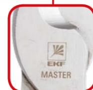
Режущие кромки имеют дополнительную закалку токами высокой частоты до 62 HRC
