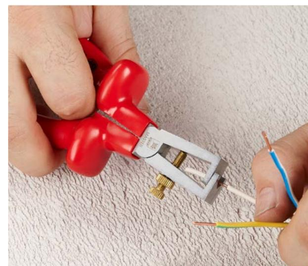
Диэлектрический шарнирно-губцевый инструмент **серии Expert** – надежный инструмент для выполнения электромонтажных работ под напряжением до 1000 В. Каждая единица продукции прошла тестирование на пробой и допущена к использованию при электромонтажных работах до 1000 В. Инструмент отвечает требованиям IEC 60900:2004.
