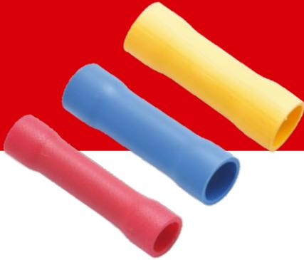
Гильзы ГСИ ЕКФ состоят из медной трубки, сверху имеется изолирующая оболочка из поливинилхлорида (ПВХ), которая служит надежной защитой гильзы от воздействия внешней среды и механических повреждений. Стопорная высечка, расположенная по центру гильзы, определяет глубину захода провода в соединитель. Предназначены для соединения встык медных проводов методом опрессовки. Способ монтажа – опрессовка поверх изолирующего корпуса, при этом электрическому контакту обеспечена герметичность.
