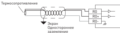
Рис. 2 – Подключение дискретных датчиков температуры
