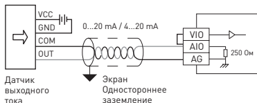
Рис. 5 – Подключение аналоговых входов (входной сигнал – ток)
