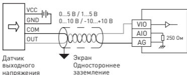
Рисунок 5 – Подключение аналоговых входов (входной сигнал – напряжение)
