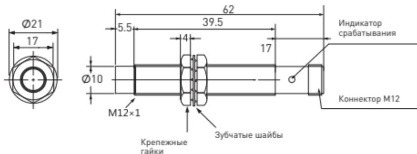
Рис. 6 – Чертеж датчика PROXIS-2-12 с разъемным подключением M12
