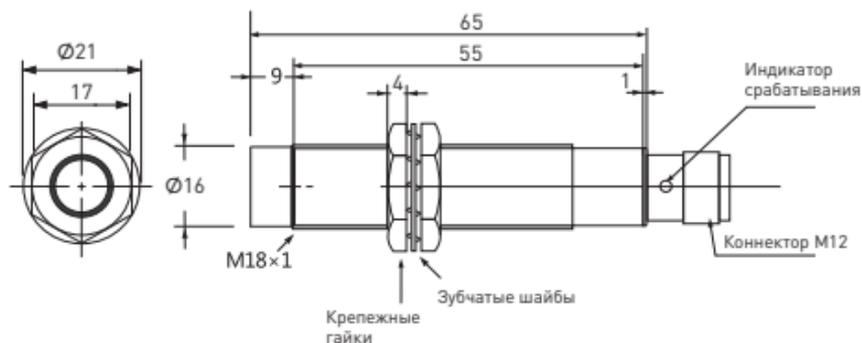
Рис. 8 – Чертеж датчика PROXIS-2-18 с разъемным подключением M12
