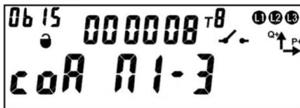
Рисунок 155. Окно текущего состояния пломбы.
