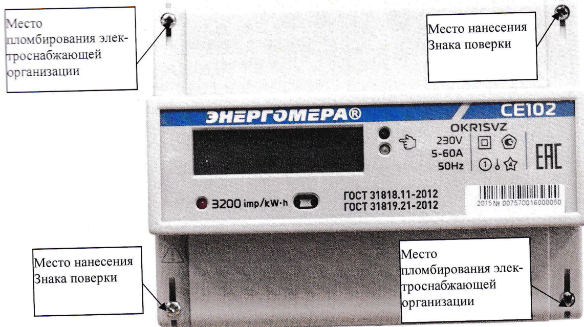
Рисунок 5 – Внешний вид счетчика CE 102 R8
