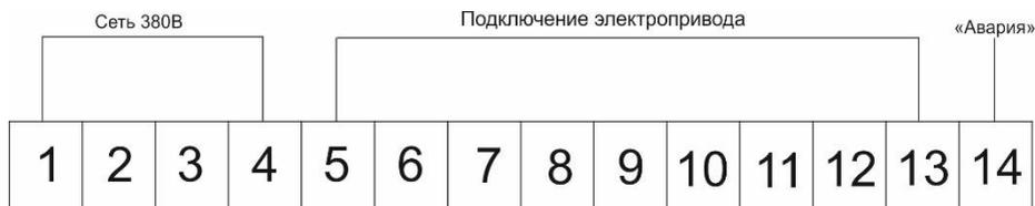
Рисунок 6 - Схема подключения клемм на ШУЭП ШУЭП 6 000.000.380 basic и 7 000.000.380
