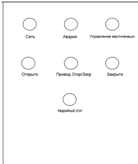
Рисунок 5 – Передняя панель модели ШУЭП-9 001.000.380
