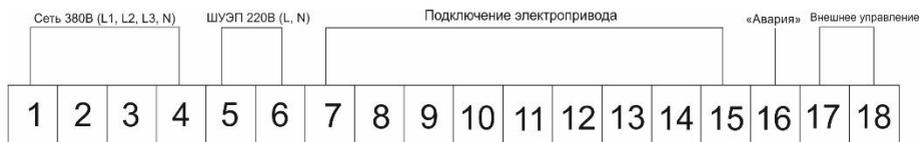
Рисунок 8 - Схема подключения клемм на ШУЭП 9 000.000.380
