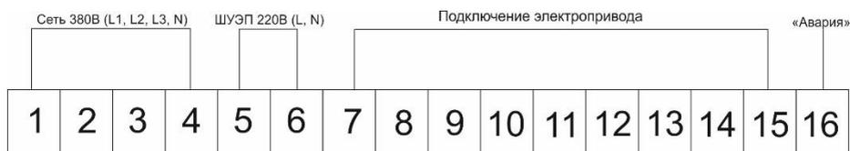
Рисунок 7 - Схема подключения клемм на ШУЭП 8 000.100.380
