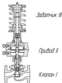
3.1. Регулятор состоит из трех элементов: клапан, привод, задатчик. Клапан регулятора при отсутствии импульса нормально открыт.
