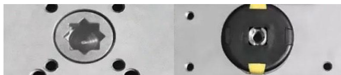
соединение привода и арматуры ISO-5211
