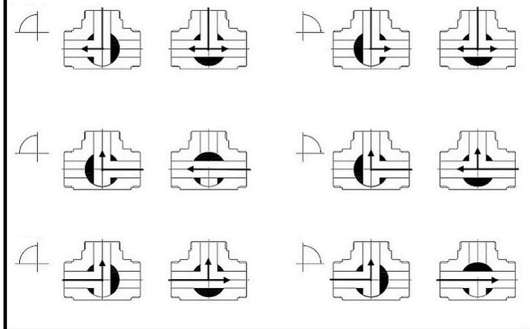
Рисунок 1 – Схемы потока
