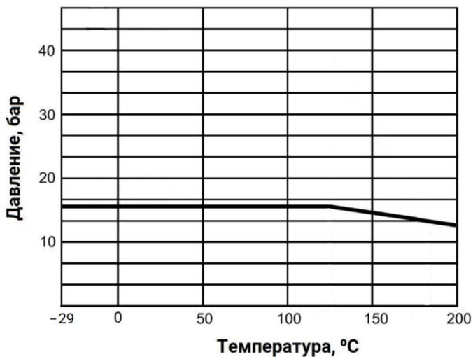
Рисунок 2 – График зависимости давления от температуры
