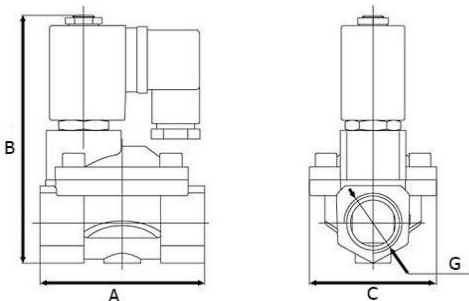
Рисунок 2 – Размеры клапана
