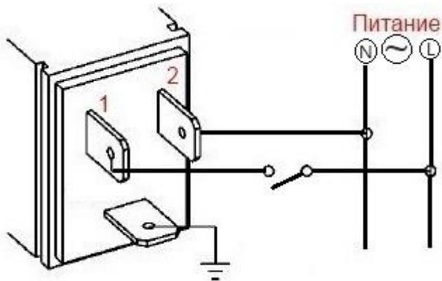
Рисунок 4 – Схема подключения на переменное напряжение
