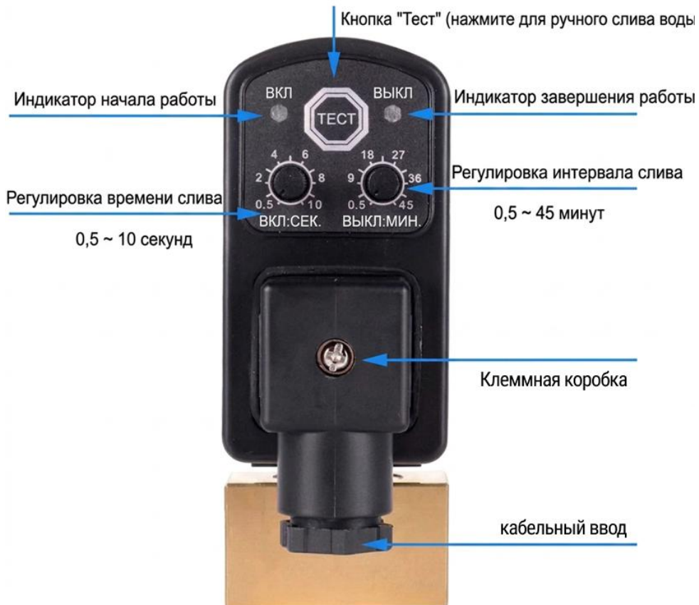
Рисунок 4 – Обозначение элементов на таймере слива
