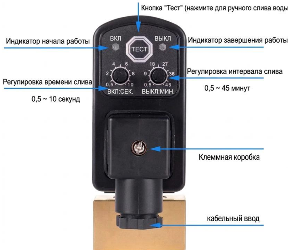
Рисунок 4 – Обозначение элементов на таймере слива
