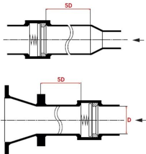
5.6. Предпочтительным является монтажное положение на наклонном или вертикальном трубопроводе при направлении движения воды снизу-вверх.
