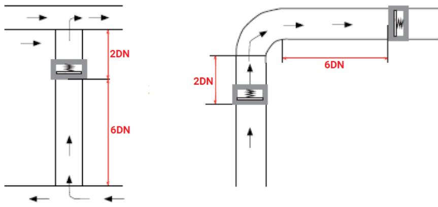
5.8. Установка клапана сразу за изгибом трубопровода не рекомендуется. Турбулентный поток может привести к быстрому износу пружины, в результате чего сокращается срок службы клапана и способствует скорейшему его выходу из строя
