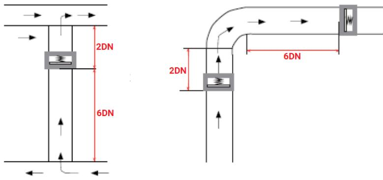
5.8. Установка клапана сразу за изгибом трубопровода не рекомендуется. Тurbulentный поток может привести к быстрому износу пружины, в результате чего сокращается срок службы клапана и способствует скорейшему его выходу из строя
