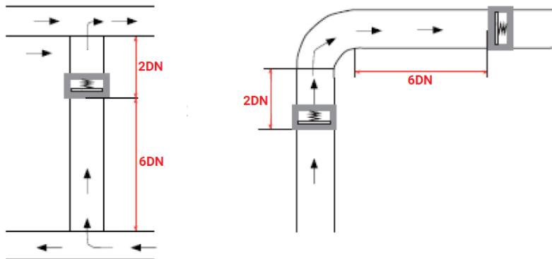
5.8. Установка клапана сразу за изгибом трубопровода не рекомендуется. Тurbулентный поток может привести к быстрому износу пружины, в результате чего сокращается срок службы клапана и способствует скорейшему его выходу из строя.
