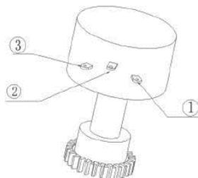
Поверните вручную клапан в положение полного открытия до перемещения концевого выключателя, измеряя сопротивление с помощью мультиметра, остановите сопротивление между (2) и (1)  $35\Omega \sim 60\Omega$ . Если значение неверно, отрегулируйте его, поворачивая приводную шестерню потенциометра.
