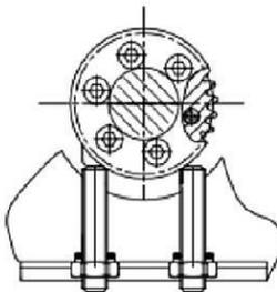
Рисунок 7 – Механические упоры
