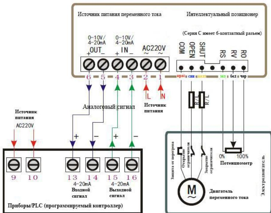
Рисунок 3 – Схема подключения на 220 В
