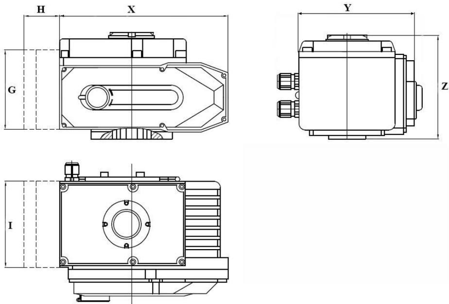
Рисунок 2 – Размеры приводов 030-040
