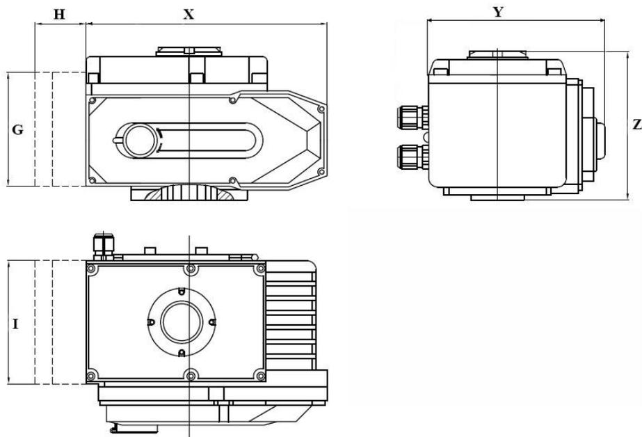
Рисунок 2 – Размеры приводов 005-015
