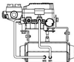
Схема монтажа воздухопровода с приводом двустороннего действия
