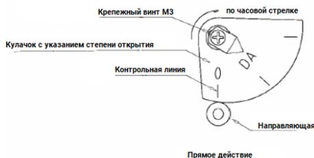
7.2.1. Заблокируйте эксцентрик и потом настройте нулевую точку и шкалу. Прикрепите к штоку плату индикации уровня открытия при помощи винта М3. В это время установите плату индикации уровня открытия в положение, при котором она будет соприкасаться с нулевой линией.
