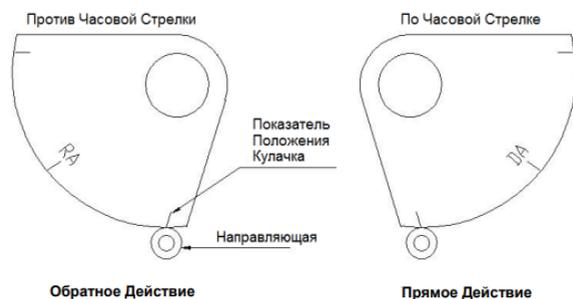
7.1.1. Используйте DA сторону эксцентрика, чтобы повернуть основной шток привода по часовой стрелке (вид со стороны передней крышки позиционера) во время ввода штока обратной связи. Используйте RA сторону, чтобы повернуть его против часовой стрелки (обратное действие). Правильно прикрепите эксцентрик к буртику штока обратной связи.
