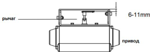
6.1.7. Прикрепите позиционер к кронштейну. Закрепите зажимной штифт в центре главного вала позиционера и вставьте соединительную планку в прорезь вилочного рычага, чтобы ее можно было зафиксировать на пружине рычага вилки. Этим достигается выравнивание осей основного вала позиционера и центра штока привода. Несоосность валов позиционера и привода значительно снижает срок службы позиционера.
