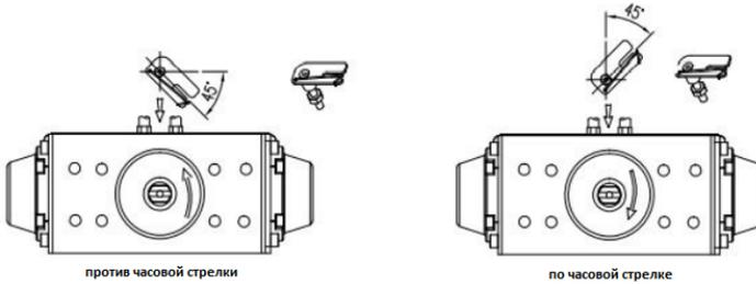
6.1.6. После установки законтрите гайки под вилкообразным рычагом. Убедитесь, что верхняя точка рычага находится в пределах 6-11 мм от верхнего кронштейна.
