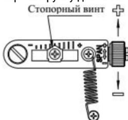
7.4.2. После регулировки диапазона нулевая точка изменится, и ее следует заново установить. После настройки нулевой точки снова отрегулируйте диапазон. Повторите настройку нулевой точки и диапазона несколько раз, пока привод не будет останавливаться в позиции 0% хода при нулевом входном сигнале и в позиции 100% при стопроцентном входном сигнале соответственно.
