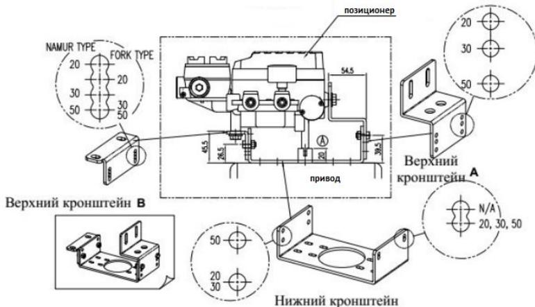
6.1.2. Высота (H) вала привода делится на 3 типа: 20, 30 и 50 мм. Соберите кронштейн, используя монтажные отверстия в соответствии с имеющейся высотой вала привода.
