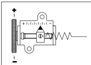
7.3.2. В случае работы с пружинным приводом одностороннего действия, следует проверить, чтобы в нулевой точке он был настроен на стандартное давление. Если нет, повторите настройку нуля.
