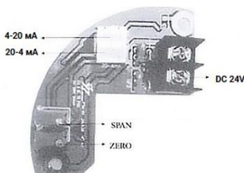
7.8.1. К проводному интерфейсу модуля обратной связи подключается стабилизированное напряжение DC24V.
