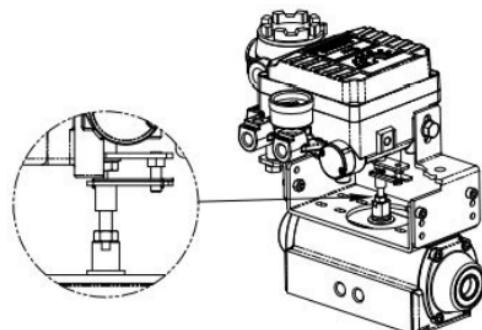
Схема установки при использовании вилкообразного рычага обратной связи
