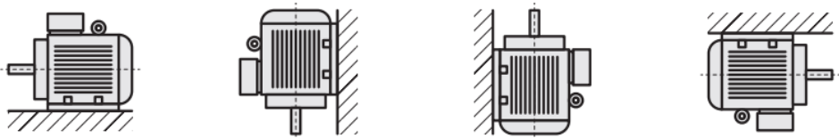
Рисунок 3 – Монтажное положение электродвигателя исполнения IM1081
