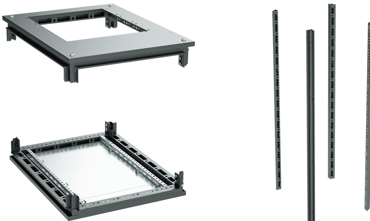
Стойки R5КМН\*\*\*\* устанавливаются в направляющие на крыше и дне R5КТВ\*\*\*\* и фиксируются болтами. Точность позиционирования вертикальных силовых профилей относительно дна и крыши обеспечивается конструктивно. Сборка осуществляется с помощью шестигранника и гаечного ключа.
