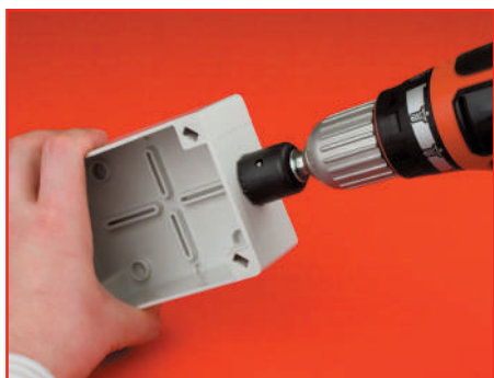
1 этап. Просверлить отверстия необходимого диаметра
