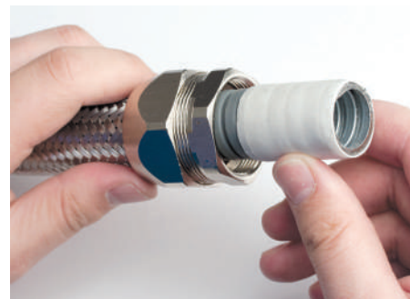
3. При использовании металлорукава в гладкой оболочке переходите к пункту 4. При использовании герметичного металлорукава накрутите на край уплотнительную муфту для металлорукава (белого цвета) для получения герметичного соединения. Совет: сдвиньте оплетку от края для удобства монтажа уплотнительной муфты
