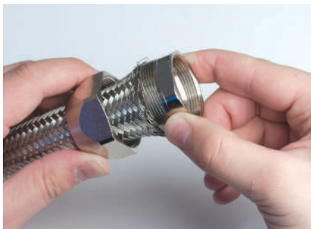
2. Установите промежуточный корпус под оплетку, предварительно удалив скотч с металлорукава. Плотнo зафиксируйте гайку и промежуточный корпус, тем самым закрепив оплетку металлорукава в аксессуаре
