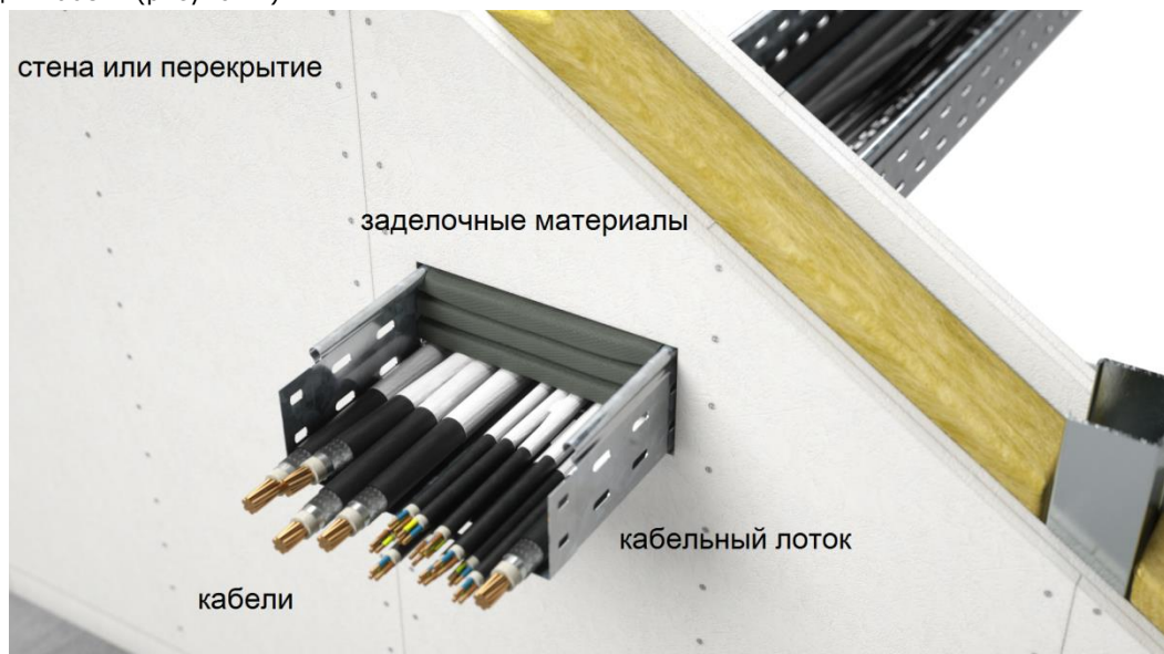
Рисунок 1 – Схема кабельной проходки
