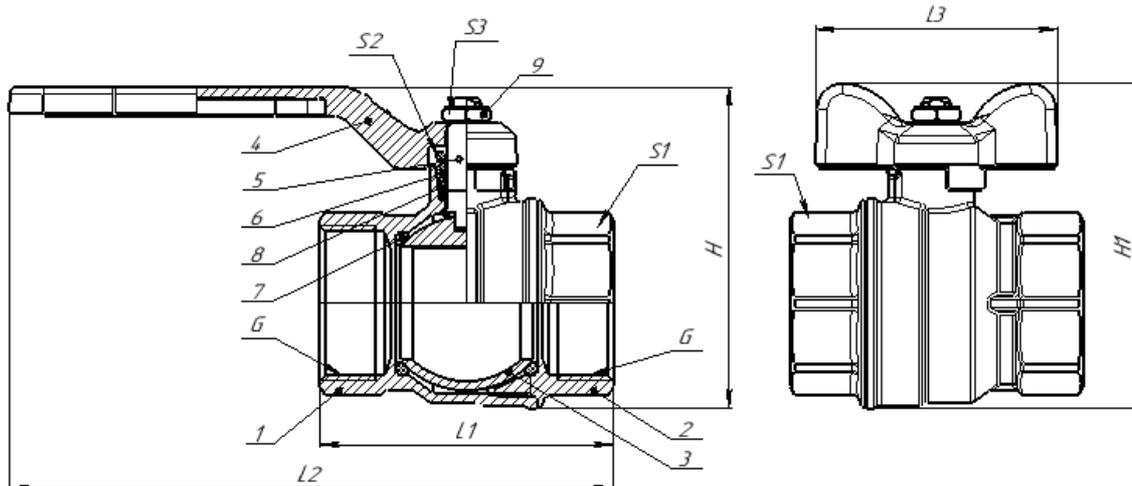
Рис.2 Эскиз крана комплектации Рс (рукоять стальная)
