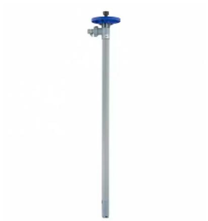
Насос DINO HD-PPHT1000 Назначение: Данный насос идеально подходит для перекачки жидкостей, не склонных кристаллизоваться, полимеризоваться, склеиваться и т.д. Не имеет торцевого уплотнения, что обеспечивает более широкий спектр применения. Возможные материалы корпуса: полипропилен (PP). Длина насосной части 1000 мм.
