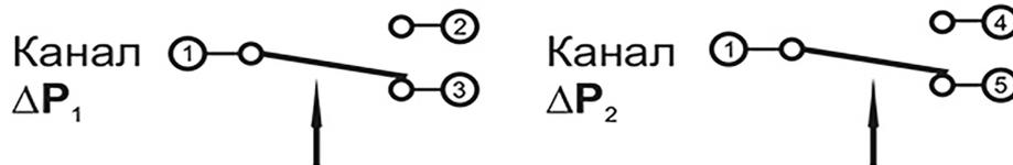
В исходном состоянии, при отсутствии перепада давления на входах, контакты «1-3» - замкнуты, а контакты «1-2» - разомкнуты для канала  $\Delta P_1$ ; контакты «1-5» - замкнуты, а контакты «1-4» - разомкнуты для канала  $\Delta P_2$ .
